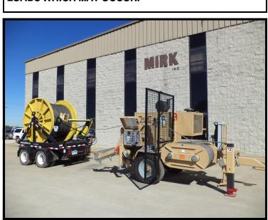
OPTIONAL ELECTRONICPULL AND SPEED RECORDER REMOVEABLE OPERATOR PROTECTION SCREEN ADDITIONAL MANUAL STABILIZER JACK FOR UNDERGROUND PULLING OPERATIONS. ADJUSTABLE SIDE TO SIDE FAIRLEAD ROLLER FOR PULLING LINE. WEIGHT: 13,500 LBS. RIGID AXLE FOR TOWING AT MAX. SPEED AT 18.6 MPH WITH MECHANICAL PARKING BRAKE. 315/60R22.5 RADIAL TIRES.
