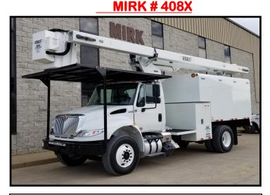
VERSALIFT VO 260-1: 60' PLATFORM HEIGHT 65' WORKING HEIGHT 50' HORIZONTAL REACH 350 LBS.BUCKET CAPACITY 245° UPPER BOOM,INSULATED TO 46KV 125° LOWER BOOM,WITH FRP INSERT HYDRAULIC TOOL CIRCUIT AT BUCKET SINGLE HANDLE UPPER CONTROL 360°CONTINUOUS ROTATION
