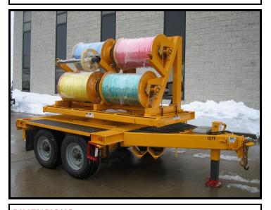
DIMENSIONS: LENGTH: 92" WIDTH: 52" HEIGHT: 53" WEIGHT: (LESS ROPE) 2100 LBS. MOUNTED ON TANDEM TRAILER FOR TRANSPORT 360 DEGREE TURRET ROTATION ON TRAILER CAN PULL FROM ANY DIRECTION WHILE MTD. PINTLE STYLE HITCH SAFETY CHAINS 7 PRONG TRAILER PLUG
