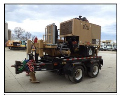
PULLER PERFORMANCE: MAX PULL: 40,300 LBF SPEED @ MAX. PULL: 1.4 MPH MAX. SPEED: 3.1 MPH PULL @ MAX. SPEED: 17,985 LBF 280 HP DIESEL ENGINE GROUNDING CONNECTION POINT HYDRAULIC FRONT STABILIZER JACK
